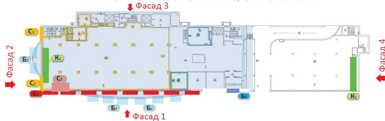
ПЛАН-СХЕМА размещения информационных конструкций на фасадах здания
